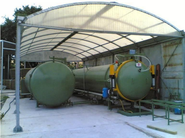
IMP-VPD avec une ouverture latérale de 6m dans la région des Marches (Italia)
