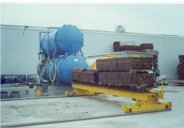
IMP-VPD avec système de chargement et de déchargement motorisé à Barcelone (Espagne)
