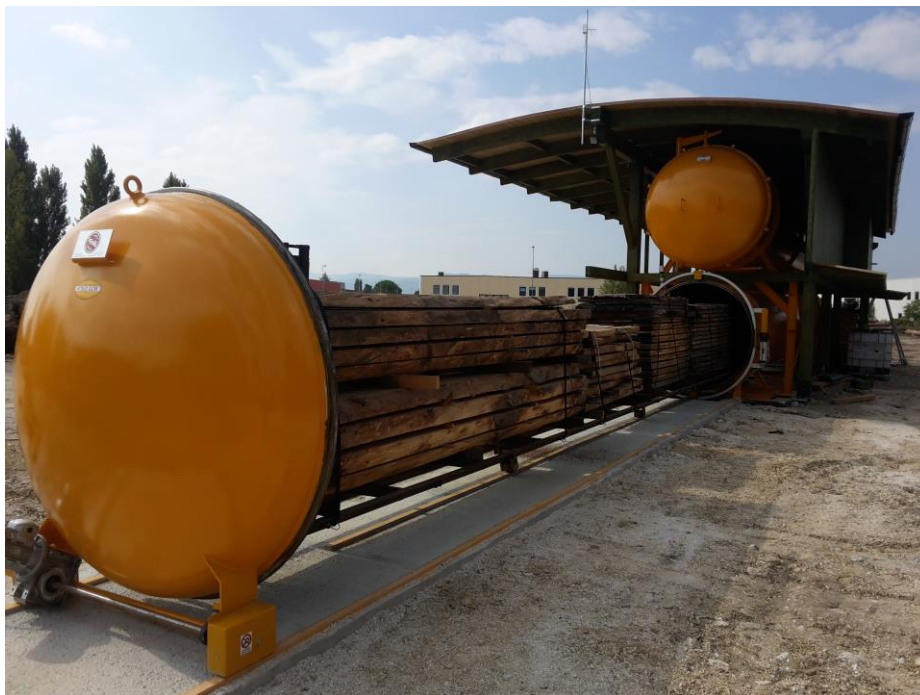
IMP-VP avec double cuve pour deux produits d'imprégnation
