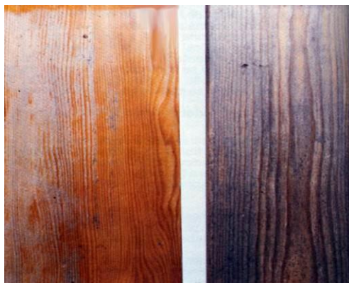
Figure 3.1: Dégradation du bois par les rayons UV
